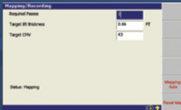
Problemlose Eingabe der erforderlichen Bahnenanzahl für die Verdichtungsarbeit
