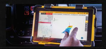
Das Trimble Siteworks Positionierungssystem für Bauleiter beinhaltet die SPS986 oder SPS785 GNSS Smart Antenne, T7 oder T10 Tablet und Siteworks Software. Es ermöglicht Bauleitern die uneingeschränkte Nutzung von Office-Softwarepaketen und problemloses Arbeiten mit Daten und 3D-Modellen im Feld – ohne extra Laptop.
