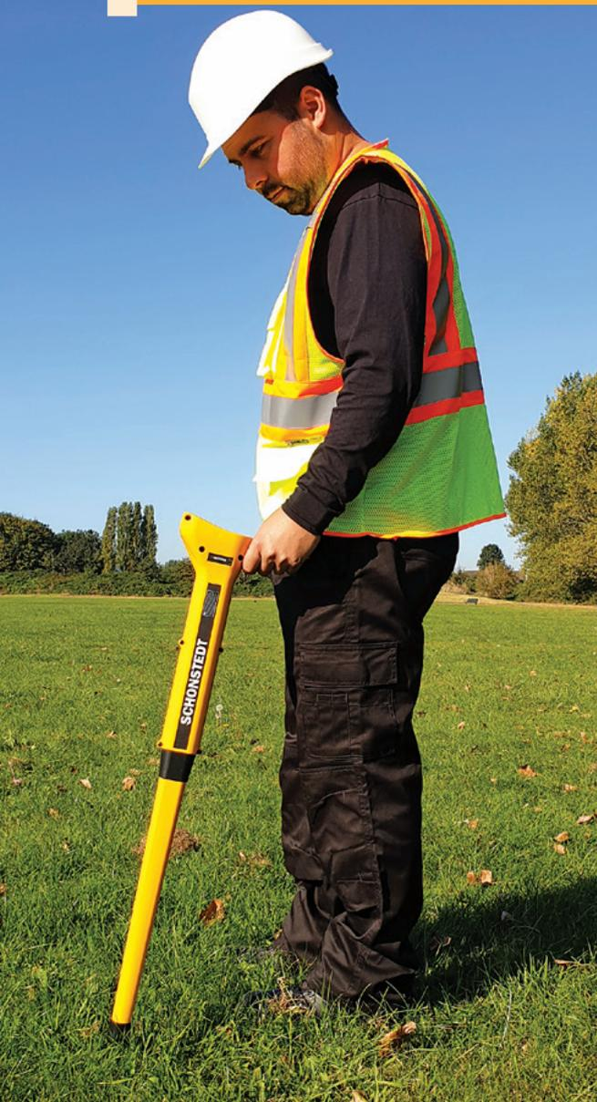
Das Maggie ist die perfekte Kombination aus Zuverlässigkeit und Ergonomie beim Orten von ferrometallischen Gegenständen im Untergrund bis zu einer Tiefe von 6,10 Metern.
