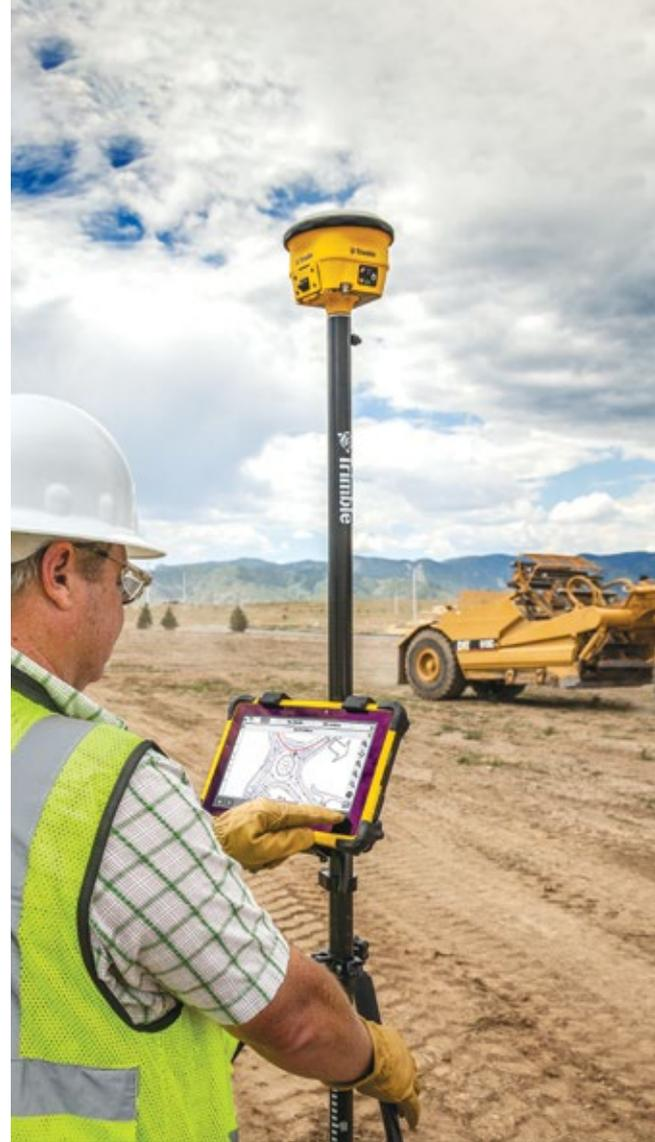
Trimble bietet mit VRS Now einen Korrekturdatendienst zur exakten Standortbestimmung für Aufmaß, Absteckungsarbeiten, Baustelleneinrichtung und Baumaschinensteuerung.
