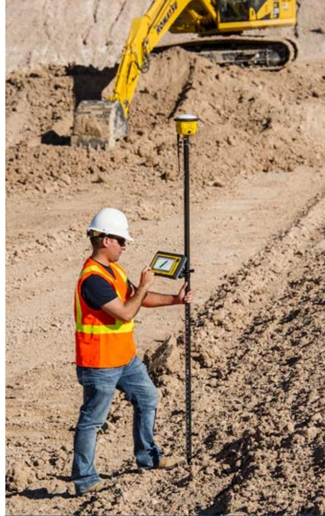
Trimble bietet mit VRS Now einen Korrekturdatendienst zur exakten Standortbestimmung für Aufmaß, Absteckungsarbeiten, Baustelleneinrichtung und Baumaschinensteuerung.
