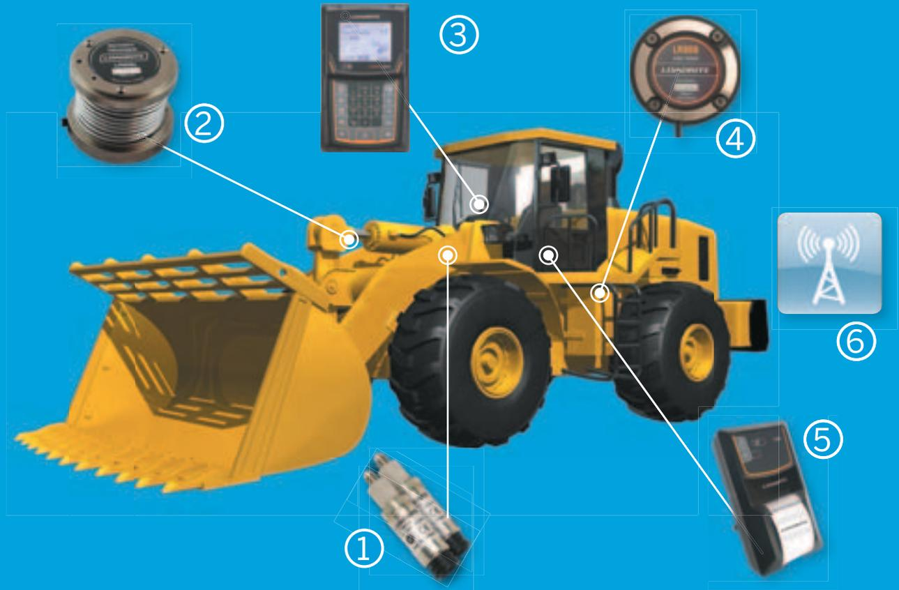
1. Druckwandler: Die Druckwandler sind an das Hydrauliksystem des Laders angeschlossen. Sie messen den Hydraulikdruck in den Hebezyllindern, wenn die Last gehoben wird.
