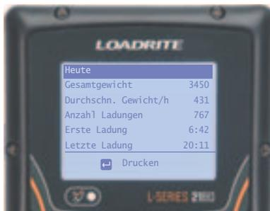
Feedback mit Kennzahlen für den Bediener im Führerhaus während der Schicht
